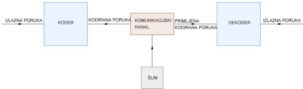
U koderu se kodira ulazna poruka i dobivamo kodiranu poruku. Kodirana poruka se šalje putem komunikacijskog kanala u kojemu se dodaje greška. Dekoder prima izmijenjenu kodiranu poruku i dekodira je kako bi se dobila izlazna poruka.
